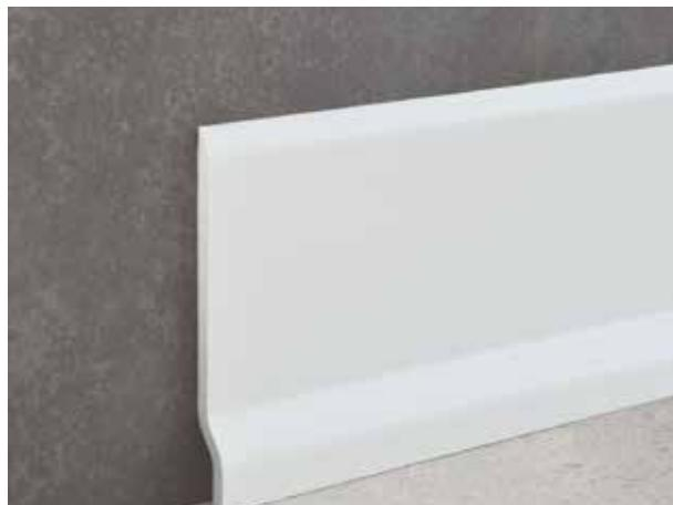
El zócalo BA700 es un zócalo de PVC para pegar. El perfil presenta un pequeño racor en la parte superior para favorecer el encolado y evitar la acumulación de polvo y suciedad en el borde, en la parte inferior el racor es de mayores dimensiones (11 mm) para compensar el espacio que se deja durante la instalación entre el pavimento y el revestimiento, que se llena con cola o materiales aislantes, para permitir pequeños movimientos de asentamiento y puentes acústicos.
